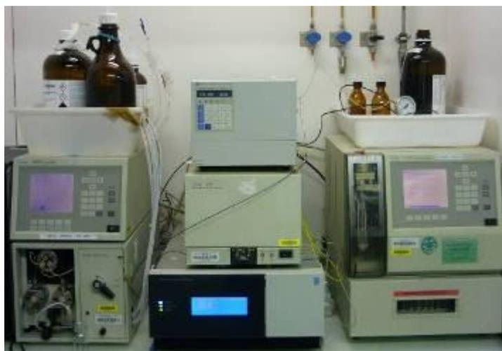
**Figure II-10.** Dispositif d'analyse par CLHP-FLD
