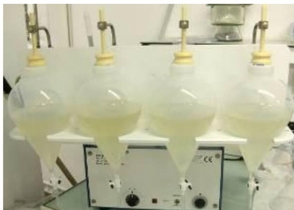
**Figure II-4.** Extraction de dépôts totaux réalisée dans des ampoules de 2 L en teflon<sup>®</sup> à l'aide d'un agitateur Agitelec AG
