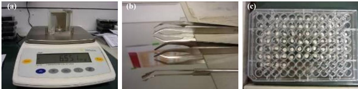
**Figure V-16.** (a) Balance micrométrique utilisée pour peser les nacelles d'échantillon, (b) Matériel utilisé pour préparer les nacelles : miroir, pincettes et spatule en acier inoxydable, (c) Plaquette contenant les échantillons pour prêts pour l'analyse
